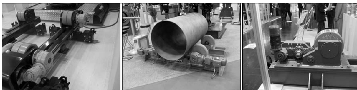
Рис. 6. Роликовые вращатели с различными компоновочными схемами приводов
