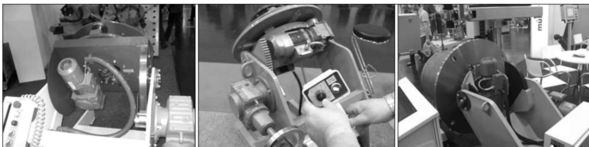
Рис. 1. Универсальные позиционеры, в приводе вращения которых используется асинхронный электродвигатель
