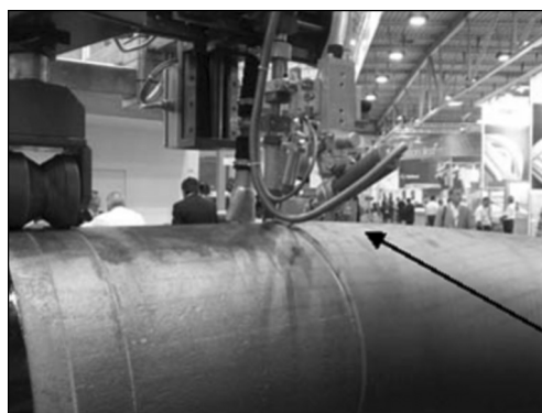
Рис. 8. Рабочий орган следящей системы, смонтированный на сварочной головке
