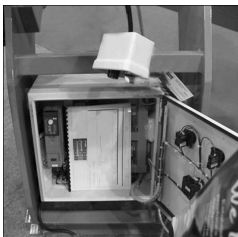
Рис. 3. Блок управления вентильного электродвигателя
